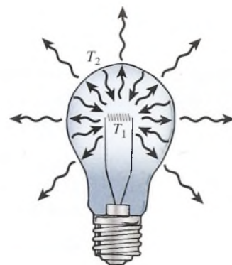
Figura 18.8 La energía neta emitida por un radiador en un entorno que tiene diferente temperatura.
