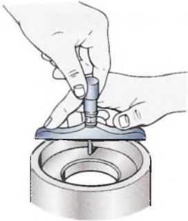
Figura 3.6 Cómo medir la profundidad de un reborde con un micrómetro de profundidad.
