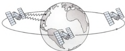
Figura 10.13 Los satélites geosincrónicos están ubicados de modo que puedan moverse alrededor de la Tierra en órbitas ecuatoriales con un periodo igual al de la Tierra (un día).
