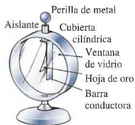
Figura 23.7 Electroscopio de hoja de oro.
